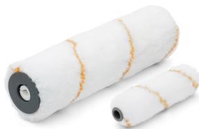
Валик X6 PA NoLoss произведен из полиамида подходит для покрытий с высокой вязкостью, систем пассивной противопожарной защиты, также подходит для покрытия толстым слоем. Высота ворса 13мм.
